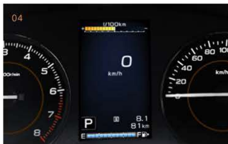
04. АСПАПТАР ТАҚТАСЫНЫҢ ДИСПЛЕЙІ*1 Үлкен 4,2 дюймдік түрлі түсті СК-дисплейден алынған ақпарат енді әлдеқайда жеңіл оқылып, жүргізуші назарын жолдан алаңдатпайды.
