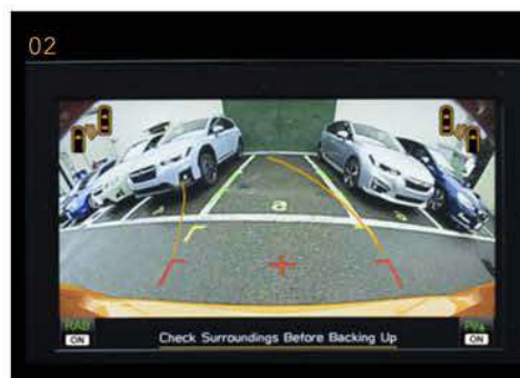
02. АРТҚЫ КӨРІНІС КАМЕРАСЫ*1 Subaru XV көлігімен қаланың тар көшелерінде маневр жасау өте оңай. Артқа жүру берілісі қосылған кезде, камера аспаптар тақтасының дисплейіне көлікті тұраққа қою үшін көмектесетін түрлі түсті кескінді шығарады.
