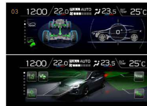
03. КӨПФУНКЦИОНАЛЫ ДИСПЛЕЙ*1 Аспаптар тақтасының үстіңгі бөлігінде автокөлік туралы пайдалы ақпарат беретін 6,3 дюймдік сұйық кристалды көпфункционалы дисплей орналасқан. Навигация жүйесі сапар туралы толық жіті ақпаратты көрсетеді.
