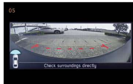
05. АЛДЫҢҒЫ КӨРІНІС КАМЕРАСЫ Автокөліктің алдында орналасқан камера аспаптар тақтасының дисплейіне автокөлік алдында тұрған заттың түрлі түсті кескінін шығарады, осылайша тұраққа қою кезіндегі көріністі жақсартады.
